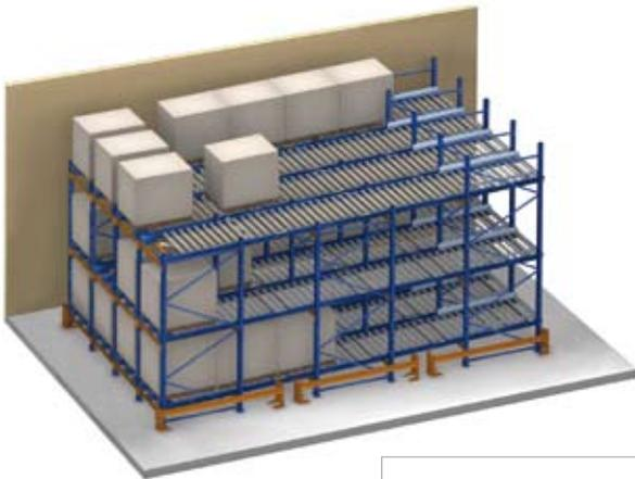
En las estanterías para paletización dinámica los niveles de carga están formados por rodillos, colocados con un ligero desnivel para permitir el deslizamiento de los pallets. Los pallets entran por la parte más alta de la estantería y se desplazan por gravedad y a velocidad controlada hasta el extremo contrario, acumulándose uno tras otro y quedando a disposición del usuario. Al retirar el primer pallet almacenado, el segundo ocupa su lugar.
