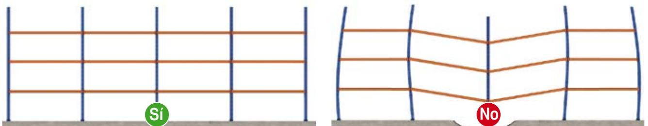
Las posibles irregularidades del suelo pueden corregirse mediante placas de nivelación, que deben estar perfectamente alojadas bajo los pies. Una incorrecta posición de estas placas aumentaría la presión sobre el piso e, incluso, podría originar el desaplome del bastidor.
