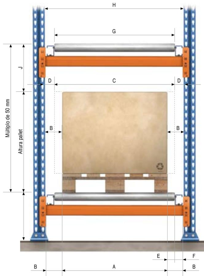
Las tolerancias que se dan en una instalación de paletización dinámica dependen de las dimensiones de los pallets, profundidad de la instalación, máquinas de elevación y transporte, etc.
