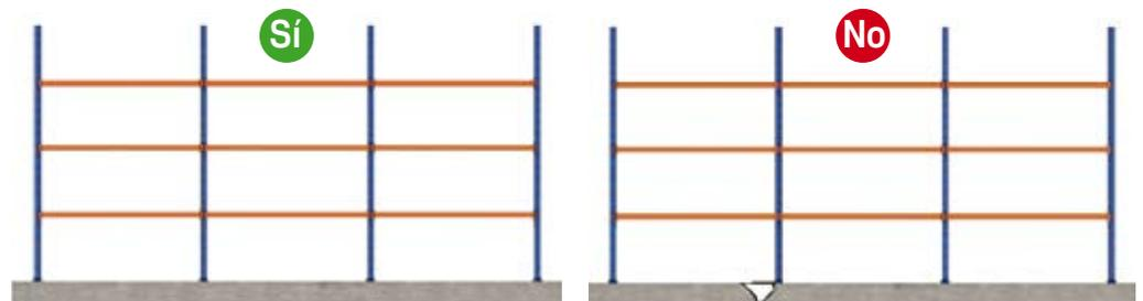
**Resistencia:** el suelo no presentará zonas donde se aprecie hundimiento alguno, dado que esto podría suponer el derrumbe de la instalación. El suelo tendrá la resistencia adecuada para soportar las cargas que el sistema de almacenamiento transmite sobre los pies.
