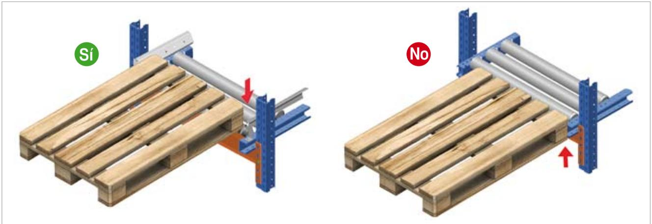
Se ha de levantar la carga al introducirla; lo suficiente para evitar golpear el protector de rodillos.
