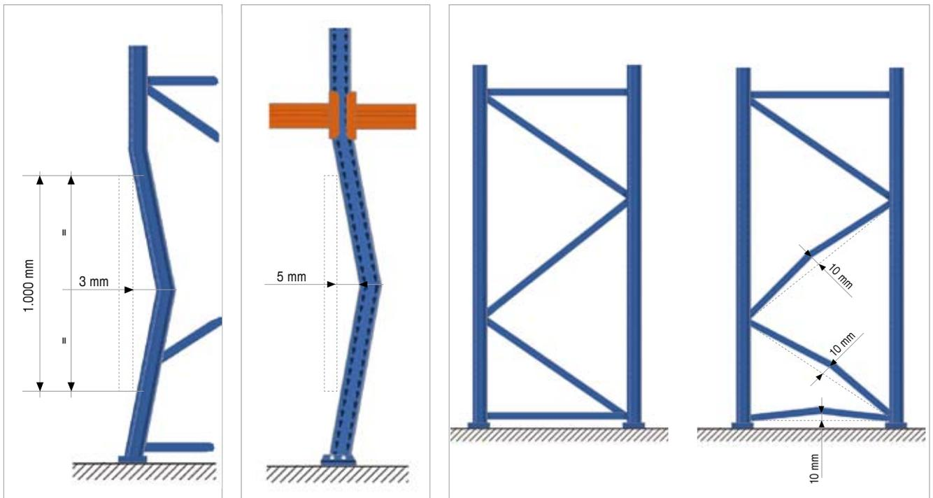
**A)** Puntales doblados en la dirección del plano del bastidor, con deformación permanente igual o mayor a 3 mm, medida en el centro de un intervalo de 1 m de longitud.
