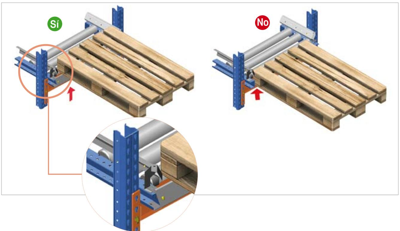
El descenso y alzado de la carga se realizará con las horquillas en posición horizontal y centradas. Esta operación tendrá lugar a velocidad mínima.
