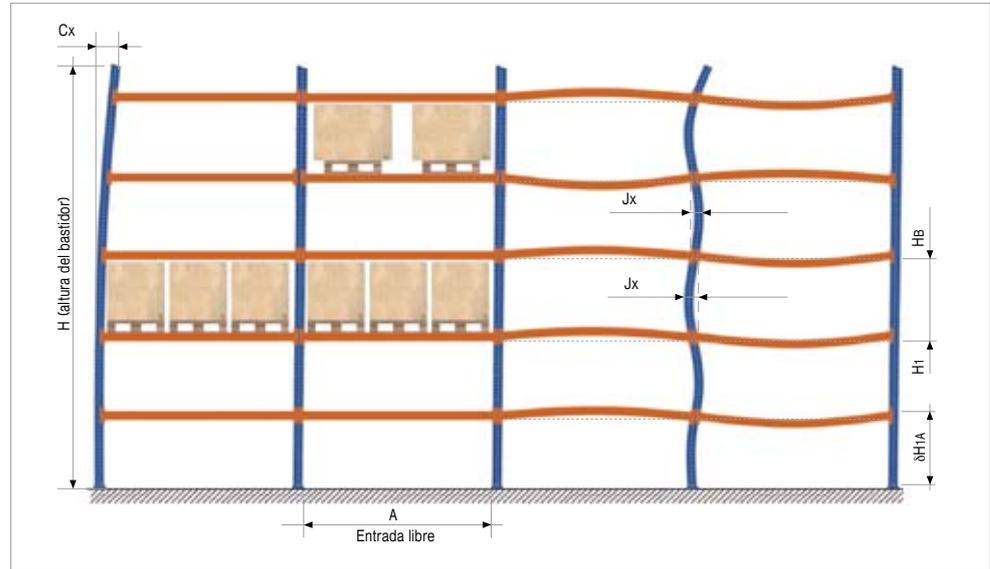
Las mediciones máximas admisibles después del montaje no tienen que superar los valores seguidamente indicados:
