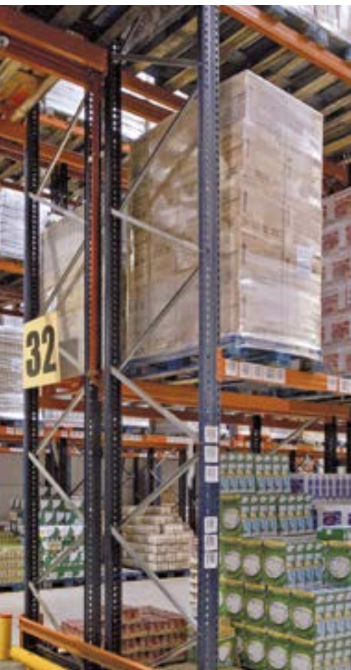
Bodega de racks selectivos con pallets manipulados por el lado de 800 mm
