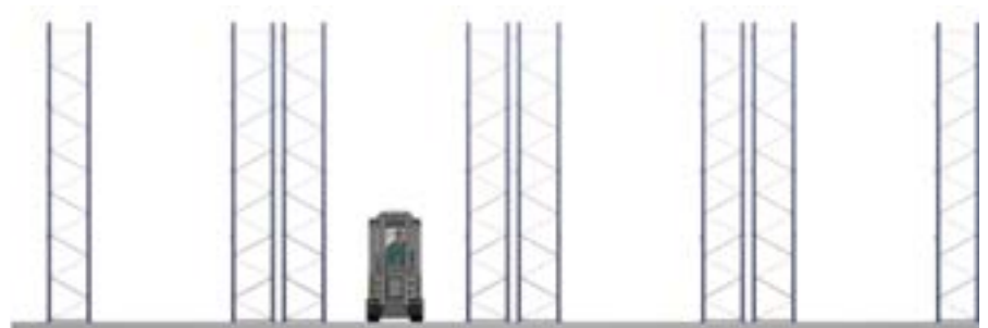
Sistema convencional más habitual, formado por un rack sencillo adosado a la pared y racks dobles centrales
