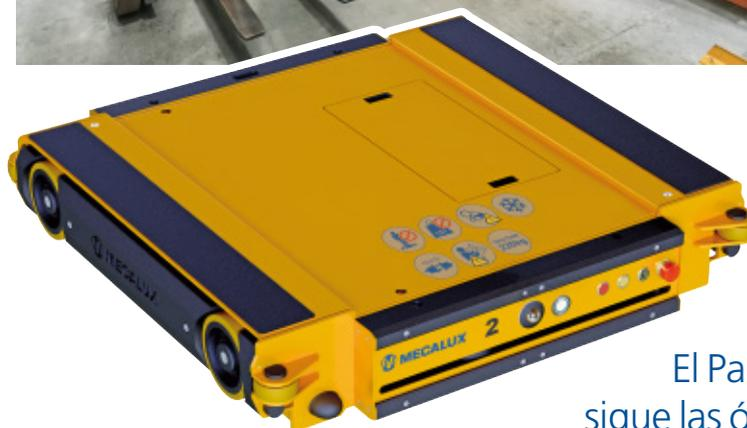
El Pallet Shuttle sigue las órdenes del operario a través de una tableta con conexión wifi
