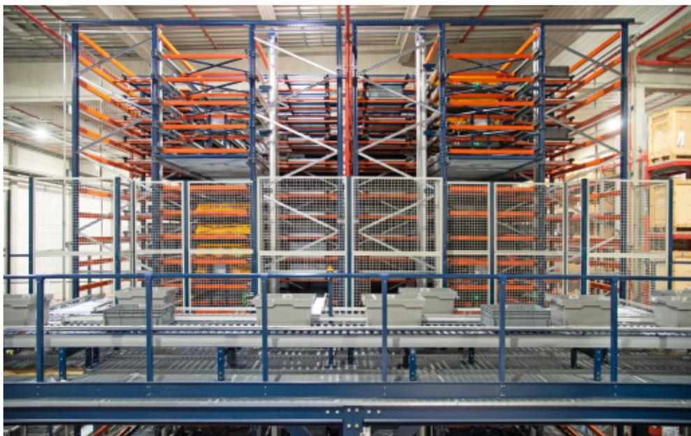
Para satisfacer las necesidades de Manitou Group, Mecalux ha instalado el Sistema Shuttle, una solución automática de almacenaje para cajas que agiliza la preparación de pedidos, proporcionando un flujo constante de productos desde el área de almacenaje hasta las dos estaciones de picking de alto rendimiento.
