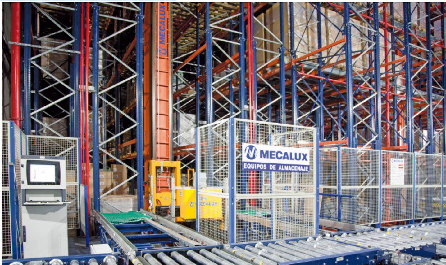
✓ La diferencia fundamental entre ellas radica en el potencial de pallets que es capaz de mover una solución con lanzaderas frente a una con transelevadores. En los ejemplos mostrados en estas páginas, el potencial de la lanzadera se multiplica por cinco. Esto significa que la combinación de Pallet Shuttle y lanzadera por cada nivel permite **aumentar considerablemente el número de ciclos**.
