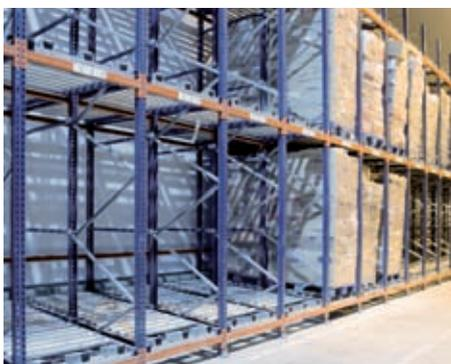
Variante de Push-back sobre rodillos con sistema LIFO, que posibilita almacenar hasta 6 pallets en profundidad.
