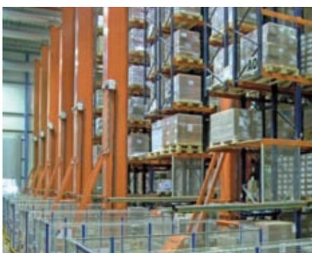
Sistema integrado de extracción trilateral gracias a un cabezal giratorio que recoge y deposita los pallets en tres posiciones.
