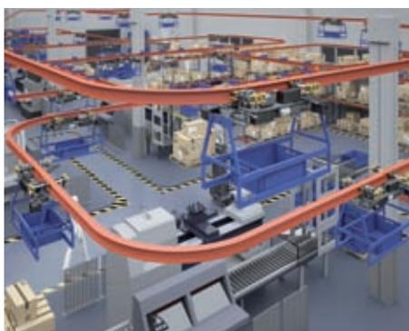
Posibilidad de instalar perfiles inclinados para así diseñar circuitos con diferentes niveles.
