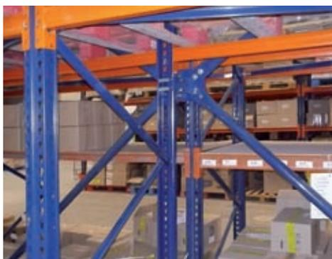
Mecalux ha diseñado un sistema de atirantado sismo resistente para racks que permite soportar los esfuerzos causados por eventos sísmicos.
