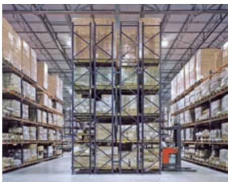
Innovador sistema antidesbloqueo que impide la manipulación accidental o deliberada del larguero, asegurando la resistencia y estabilidad de los racks.
