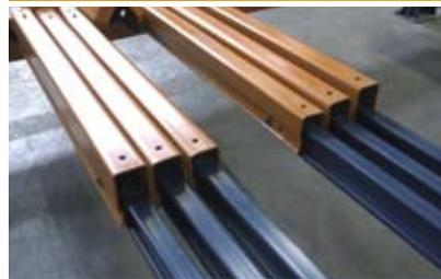
La forma en I del carril permite que los elementos de rodadura estén enhebrados a ambos lados del alma, garantizando un correcto desplazamiento y evitando la posibilidad de descarrilamiento.
