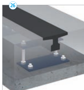
Carril de rodadura.
