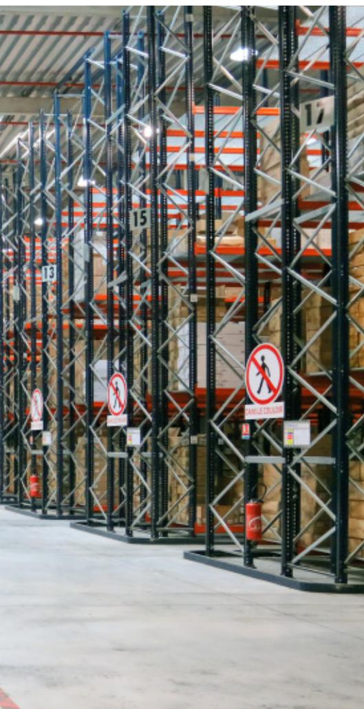
Los operarios manipulan la mercancía mediante máquinas recogepedidos en altura, que van guiadas por perfiles mecánicos instalados en ambos lados del pasillo para que circulen centradas
